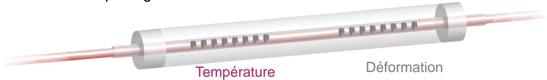
Le multiplexage est intrinsèque et cela permet de mesurer différents paramètres
