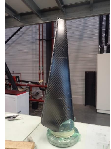
Démonstrateur échelle 1/7 d'une pale d'hydrolienne
