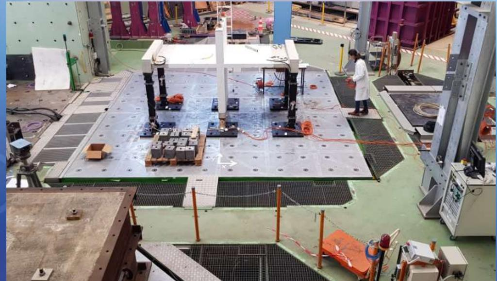
Il s'agit de pouvoir faire des mesures de déformation lors de simulation sismiques au moyen de jauges traditionnels mais aussi de capteurs à fibre optique.
