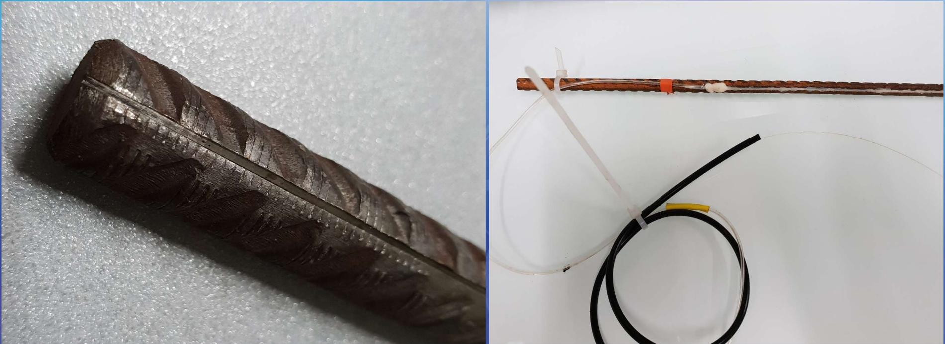
La fibre optique ainsi fixée, permet, au moyen d'interrogateur LUNA de technologie Rayleigh, de faire une mesure répartie de déformation tout au long de la barre métallique avec une résolution spatiale millimétrique et une fréquence d'échantillonnage de 50 Hz.
