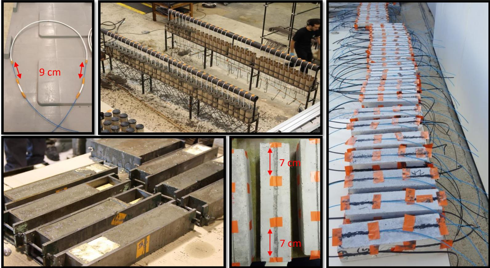
*Préparation des éprouvettes de béton avec câbles noyés et collés en surface.*
