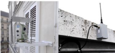
Des équipements de mesures (clinomètres, fissuromètres, jauges de déformation, etc.) sont installés sur les infrastructures de transport et les bâtiments à risque, et sont régulièrement interrogés.
